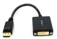
Cet adaptateur DP2DVI2 DVI/DisplayPort de StarTech.com prend en charge des résolutions d'écran d'au plus 1920x1200, vous permettant de profiter pleinement de la capacité DVI à liaison simple. Le DP2DVI2 est un adaptateur passif qui requiert un port DP++ (DisplayPort++), ce qui signifie que les signaux DVI et HDMI peuvent également être transmis via le port.
