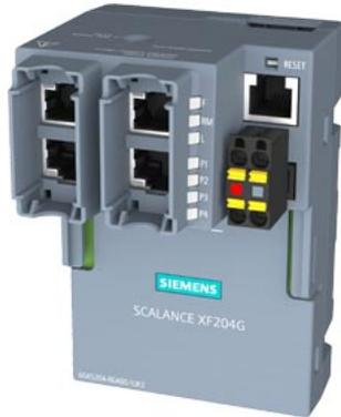
SCALANCE XF204G managebarer Layer 2 IE Switch; 4x10/100/1000 Mbit/s; RJ45; 1x Konsolen-Port; Diagnose-LED; Temp.-Bereich -40°C bis +70°C; Montage: Hutschiene/Wand mit Halblech Zubehör (separat erhältlich); PROFINET IO-Device; C-PLUG Schacht
