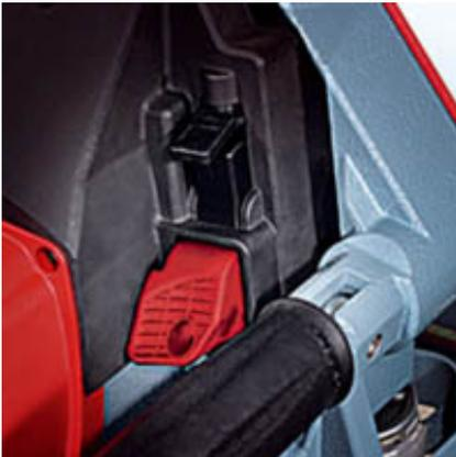
Die mechanische Sicherheitsbremse wird über die kombinierte Brems- und Ausschalt-Taste betätigt und sorgt ebenso für mehr Sicherheit wie der integrierte Spannungsabfallschalter.
