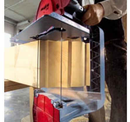
Dank hoher Drehmomente sind für die Z 4 Ec und Z 5 Ec Einsätze in Massivholz mit Schnitttiefen von 225 mm und 305 mm kein Problem.
