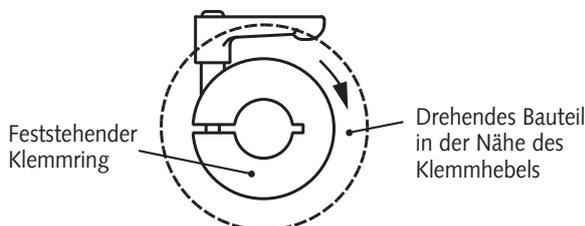
**Verwendung auf drehenden Wellen:** Der Klemmring ist mit dem Hebel so anzuordnen, dass das Griffende gegen die Drehrichtung des Klemmrings zeigt, damit kein Fanghaken entsteht. Die Drehzahl muss gering sein, damit der Klemmhebel keine starke Unwucht und Fliehkraft erzeugt. Die Bauteile müssen unbedingt durch eine Abdeckung gegen Zugriff gesichert werden.
