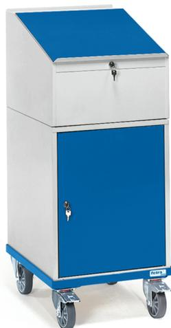
Ecritoire en tôle d'acier, revêtement époxy caisson gris RAL 7035, armature et ouvertures RAL 5007. Placard roulant à porte verrouillable avec 1 plateau fixe et 2 amovibles. Hauteur écritoire 1050/1200 mm. 2 roues pivotantes et 2 roues fixes à bandage TPE, moyeu à roulement à billes central. Freins sur roues pivotantes conformément à la Norme EN 1757-3. Charge maximum par étagère placard : 30 kg.
