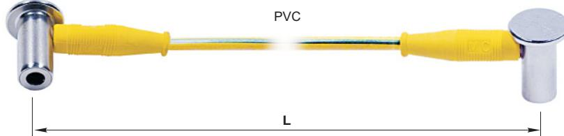
Hoch flexible Verbindungsleitungen mit grün-gelber Isolation für den Potenzialausgleich. Beidseitig mit montierter, 90° abgewinkeltem Buchse mit federnder Kontaktlamelle. Buchsen aus vernickeltem Messing mit Kontaktlamelle aus vergoldeter Hartkupferlegierung. Verschiedene Leitungsquerschnitte erhältlich.
