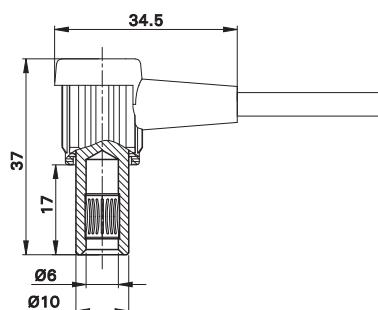
Cordons de liaison extra-souples à isolation vert-jaune pour liaisons équipotentielles. Équipés des deux côtés d'une douille à lamelles, surmoulée, coudée à 90°. Douilles en laiton nickelé avec contact à lamelles en alliage de cuivre doré. Différentes sections de câbles disponibles.
