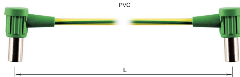
Hoch flexible Verbindungsleitungen mit grün-gelber Isolation für den Potenzialausgleich. Beidseitig mit 90° abgewinkeltem Buchse mit federnder Kontaktlamelle und umspritzter Isolation. Buchsen aus vernickeltem Messing mit Kontaktlamelle aus vergoldeter Hartkupferlegierung. Verschiedene Leitungsquerschnitte erhältlich.
