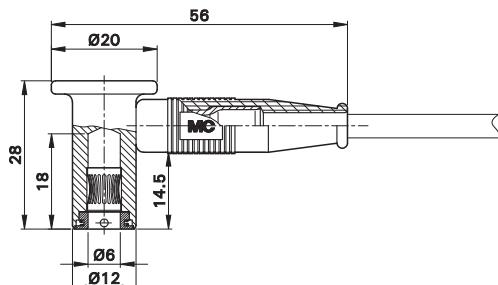
Cordons de liaison extra-souples à isolation vert-jaune pour liaisons équipotentielles. Équipés des deux côtés d'une douille à lamelles coudée à 90° assemblée. Douilles en laiton nickelé avec contact à lamelles en alliage de cuivre doré. Différentes sections de câbles disponibles.
