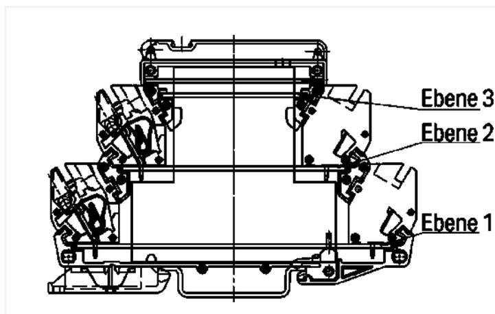
Universelles anreihbares Elektronikgehäuse, im Reihenklempenformat – Klemmenblock, 3-polig: CCC\*
