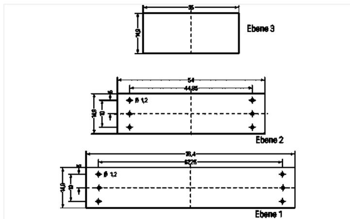
Leiterplattenabmessungen, für vertikalen Einbau: (Leiterplattendicke max. 1,5 mm) in Ebene 1; (Leiterplattendicke max. 1 mm) in Ebene 2 und 3
