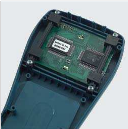
Displaybefestigungsset zur variablen Befestigung von Displays
