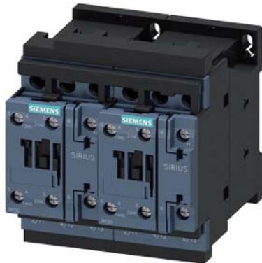
Wendekombination AC-3, 11 kW/400 V, AC110V, 50/60Hz 3-polig, Baugröße S0 Schraubanschluss elektrische und mechanische Verriegelung 2 S integriert
