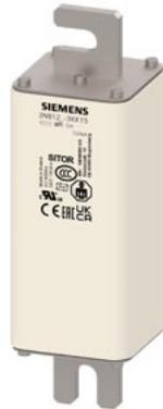
SITOR-Sicherungseinsatz Baugröße 2 630A aR 1000V dc/1250V VSI 1100V dc UL @MBC 7xIn Schraubkontakte M10 170mm geschlitzte Messer
