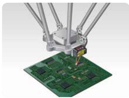
Höhenüberwachung eines Roboters
