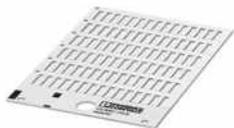
Kabelmarker, Karte, weiß, unbeschriftet, beschriftbar mit: BLUEMARK ID COLOR, BLUEMARK ID, THERMOMARK PRIME, THERMOMARK CARD 2.0, THERMOMARK CARD, Montageart: aufschieben, Kabeldurchmesserbereich: 0,6 ... 50 mm, Schriftfeldgröße: 15 x 4 mm, Anzahl der Einzelschilder: 84
