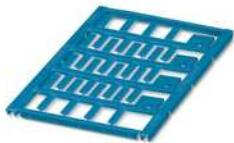
Kabelmarker, Matte, blau, unbeschriftet, beschriftbar mit: BLUEMARK ID COLOR, BLUEMARK ID, BLUEMARK CLED, PLOTMARK, CMS-P1-PLOTTER, Montageart: einschieben, Kabeldurchmesserbereich: 0,6 ... 50 mm, Schriftfeldgröße: 15 x 4 mm, Anzahl der Einzelschilder: 32
