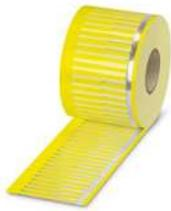
Kabelmarker, Rolle, gelb, unbeschriftet, beschriftbar mit: THERMOMARK E.300 (D)/600 (D), THERMOMARK ROLL 2.0, THERMOMARK ROLL, THERMOMARK ROLL X1, THERMOMARK ROLLMASTER 300/600, THERMOMARK X1.2, Montageart: einschieben, Kabeldurchmesserbereich: 0,6 ... 50 mm, Schriftfeldgröße: 15 x 4 mm, Anzahl der Einzelschilder: 3000
