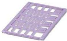
Kabelmarker, Matte, violett, unbeschriftet, beschriftbar mit: BLUEMARK ID COLOR, BLUEMARK ID, BLUEMARK CLED, PLOTMARK, CMS-P1-PLOTTER, Montageart: einschieben, Kabeldurchmesserbereich: 0,6 ... 50 mm, Schriftfeldgröße: 15 x 4 mm, Anzahl der Einzelschilder: 32
