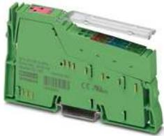
Inline, Digitalausgabeklemme, Digitale Ausgänge: 2 (NPN), 24 V DC, Anschlusstechnik: 4-Leiter, Übertragungsgeschwindigkeit im Lokalbus: 500 kBit/s, Schutzart: IP20, inklusive Inline-Stecker und Beschriftungsfeld
