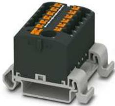
Verteilerblock, die Blöcke sind untereinander über den Leiterschacht brückbar, passende Steckbrücken siehe Zubehör, Block mit waagerechter Ausrichtung und integrierter Einspeisung, Nennspannung: 690 V, Nennstrom: 24 A, Anschlussart: Push-in-Anschluss, Abgriff, Querschnitt: 0,14 mm<sup>2</sup> - 4 mm<sup>2</sup>, Push-in-Anschluss, Sammelschluss, Bemessungsquerschnitt: 6 mm<sup>2</sup>, Querschnitt: 0,5 mm<sup>2</sup> - 10 mm<sup>2</sup>, Montageart: NS 35/7,5, NS 35/15, Farbe: schwarz
