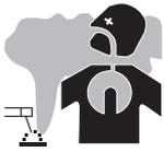
Beim Schweißen entstehen Rauchgase bzw. toxische Dämpfe, die zu Sauerstoffmangel in der Atemluft führen können. Sorgen Sie daher immer für ausreichende Luftzufuhr, eine technische Belüftung kann erforderlich sein. Ein zugelassenes Atemgerät kann bei unzureichender Belüftung geeignet sein.
