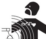
Der durch einen Leiter fließende elektrische Strom erzeugt lokale elektrische und magnetische Felder (EMF). Der Schweißstrom erzeugt ein elektromagnetisches Feld um den Schweißstromkreis und das zu schweißende Material.
