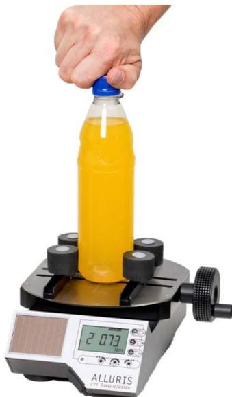
Digitale Drehmoment-Messgeräte der Baureihe CTT-300 mit automatischer Erfassung von zwei Peak-Werten sind für die schnelle, manuelle Prüfung von Sicherheitsschraubverschlüssen konzipiert. Der Verschluss wird manuell geöffnet und das maximale Drehmoment beim Lösen der Verschraubung und beim Brechen des Sicherheitsrings jeweils getrennt erfasst. Für beide Peakwerte lassen sich Grenzwerte definieren, die während der Messung überwacht und am Gerät angezeigt werden.
