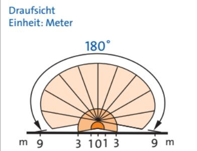
Einbauhöhe: 1,8 m bis 2 m
