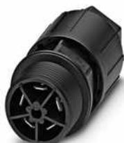
Wanddurchführung, QUICKON-Anschluss, Polzahl: 4+PE, 0,5 mm<sup>2</sup> ... 1,5 mm<sup>2</sup>, 690 V, 17,5 A, schwarz, mit QUICKON-Mutter, Leitungsaußendurchmesser: 10 mm ... 14 mm, Montagegewinde: M25, Flachsteckanschluss (für Flachsteckhülsen nach DIN 46247-2), 1,5 mm<sup>2</sup>
