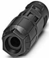
Leitungsverbinder, QUICKON-Anschluss, Polzahl: 4+PE, 0,5 mm<sup>2</sup> ... 1,5 mm<sup>2</sup>, 690 V, 17,5 A, schwarz, mit einer QUICKON-Mutter, Leitungsaußendurchmesser: 10 mm ... 14 mm, QUICKON-Schnellanschluss
