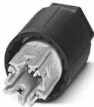
Mutter, QUICKON-Anschluss, Polzahl: 4+PE, 0,5 mm<sup>2</sup> ... 1,5 mm<sup>2</sup>, 690 V, 17,5 A, schwarz, Leitungsaußendurchmesser: 10 mm ... 14 mm
