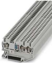
Bauelementreihenklemme, Nennspannung: 800 V, Nennstrom: 0,5 A, Anschlussart: Zugfederanschluss, 1. Etage, Bemessungsquerschnitt: 1 mm<sup>2</sup>, Querschnitt: 0,08 mm<sup>2</sup> - 4 mm<sup>2</sup>, Montageart: NS 35/7,5, NS 35/15, Farbe: grau
