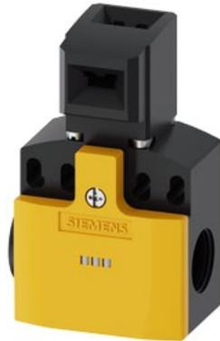
Sicherheits-Positionsschalter mit getrenntem Betätiger Kunststoffgehäuse, 50 mm Geräteanschluss 2x (M20x 1,5) Schleifschaltglieder 1S+2Ö mit 2 LEDs gelb/grün 115-230 V AC 5 Anfahrrichtungen der dazu passende getrennte Betätiger 3SE5000-0AV0. muss separat bestellt werden
