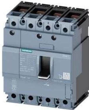
Leistungsschalter 3VA1 IEC Frame 160 Schaltvermögenklasse H Icu=70kA @ 415V 4-polig, Anlagenschutz TM210, FTFM, In=32A Überlastschutz Ir=32A fest eingestellt Kurzschlusschutz Ii=10 x In N-Leiterschutz 100% Schraubenflanschanschluss
