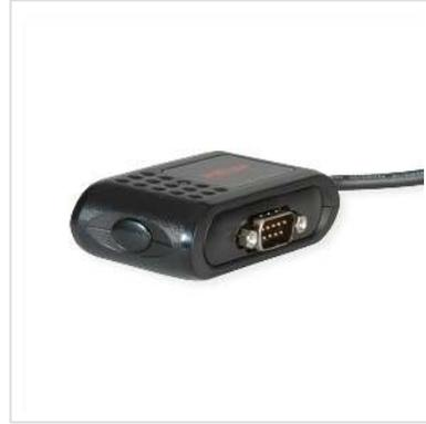
**Ermöglicht den Anschluss von seriellen (z.B. Modem) und parallelen Geräten (z.B. Drucker) über den USB-Port eines PCs oder Notebooks**
