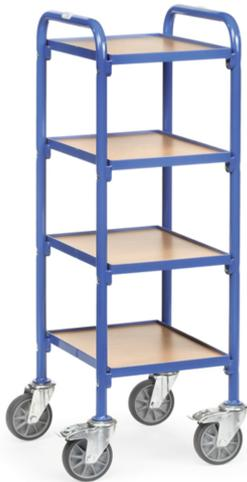
Baukasten-System: Stahlrohr- und Profilstahl geschweißt, pulverbeschichtet blau RAL 5007, Schraubkonstruktion. 4 Etagen mit Holzwerkstoffplatten, Rand 10 mm hoch. Tragkraft pro Ladefläche 60 kg. 4 Lenkrollen, TPE-Bereifung, Naben mit Rillenkugellager. 2 Stück mit Feststeller, gemäß der Europäischen Norm EN 1757-3 (Sicherheit von Plattformwagen). Zerlegte Anlieferung.
