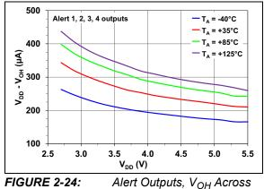
**FIGURE 2-24:** Alert Outputs, V<sub>OH</sub> Acros V<sub>DD</sub>.
