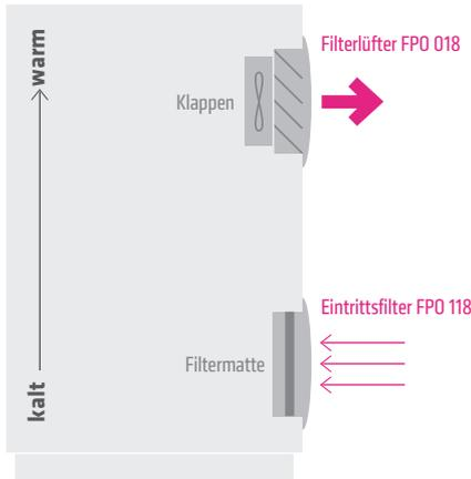
LUFTSTROMRICHTUNG "OUT": FILTERLÜFTER FPO 018
