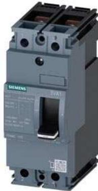
Leistungsschalter 3VA1 IEC Frame 160 Schaltvermögenklasse M Icu=55kA @ 415V 2-polig, Anlagenschutz TM210, FTFM, In=160A Überlastschutz Ir=160A fest eingestellt Kurzschlusschutz Ii=10 x In Schraubenflachanschluss
