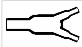
Form des Formteils: **Y-Form**Anzahl der Abzweigungen/Finger: **3**Materialcode: **3**Materialsystemcode: **10**Vorbeschichtung mit Klebemittel: **Nein**
