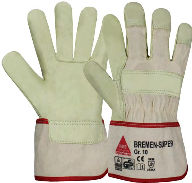
Universeller Arbeitshandschuh mit hohem Tragekomfort für Innen- und Außenbereiche, Material: Top-Rindnarbenleder hydrophobiert, Doppelnähte, gefüttert, Canvas-Stulpe, TÜV GS Schadstoff geprüft, Fingerbeweglichkeit: Leistungsstufe 5, Wasserdampfdurchlässigkeit: 10,9mg/cm<sup>2</sup>h, pH-Hautneutral, Länge: 24-32cm
