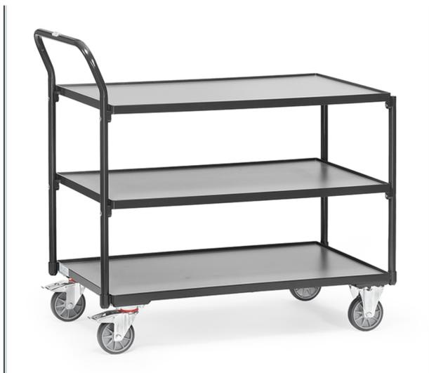
Ensemble mécano-soudé, revêtement époxy gris anthracite RAL 7016 avec 3 plateaux en mélaminé surface gris moyen, barre de poussée verticale, rebord de 12 mm. Charge maximum étagère haute et médiane : 80 kg. 2 roues pivotantes et 2 roues fixes à bandage TPE, moyeu à roulement à billes central. Freins sur roues pivotantes, conformément à la Norme EN 1757-3.
