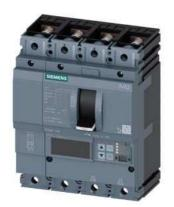
Leistungsschalter 3VA2 IEC Frame 160 Schaltvermögenklasse C Icu=110kA @ 415V 4-polig, Anlagenschutz ETU860, LSIG, In=40A Überlastschutz Ir=16A...40A Kurzschlussschutz Isd=0,6..10x In, Ii=1,5..12x In N-Leiterschutz einstellbar (OFF, bis 160%) Erdschlussschutz, abschaltbar Ig=0,4...1 x In= tg=0,05-0,8s Schraubenflachanschluss
