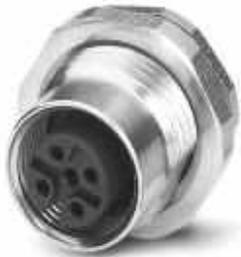
Einbausteckverbinder, 4-polig, Buchse, gerade, M12, A-kodiert, Hinterwandmontage, Pg9, Lötstifte
