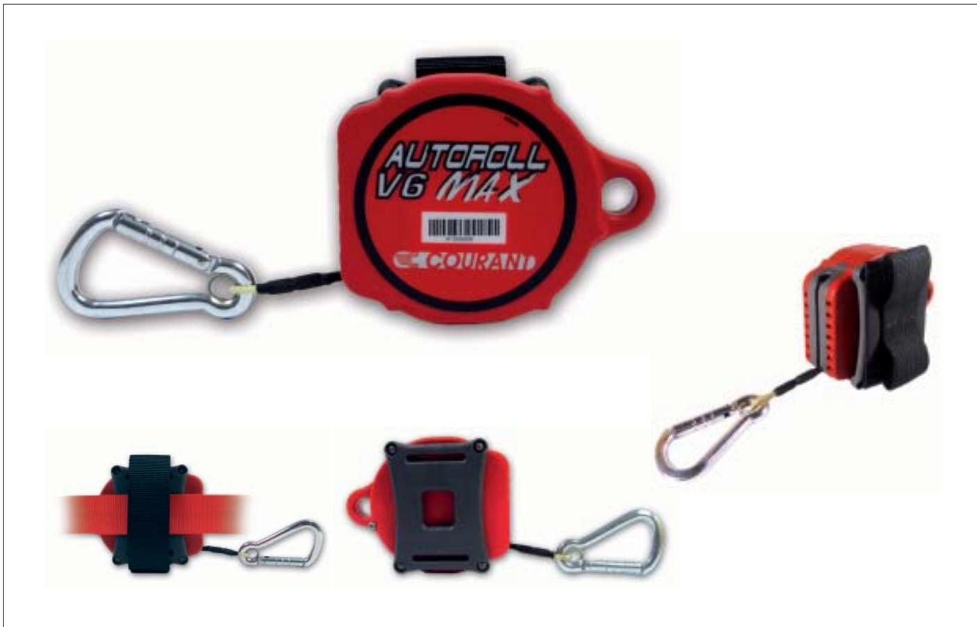
Das persönliche Sicherungsseil ermöglicht eine direkte Verbindung der Einsatzkraft mit dem Führungsseil. Das Autoroll wird einfach am Sicherheitsgurt oder der Begurtung des Atemschutzgerätes befestigt und mit dem Karabiner am Führungsseil eingehängt. Durch den automatischen Aufrollmechanismus wird ein freihändiges Arbeiten ermöglicht. Die Gefahr, dass sich das Sicherungsseil verfängt, wird dadurch minimiert. Auch mit Handschuhen ist das Autoroll gut zu bedienen.
