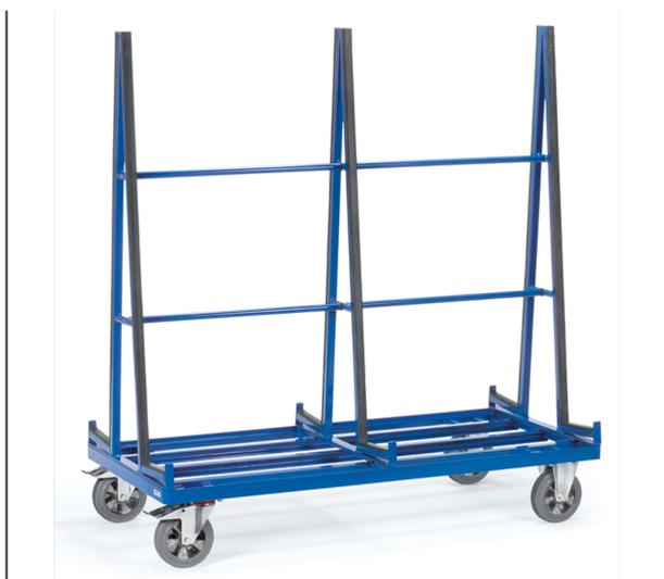
Pour un transport sécurisé des plaques de verres, bois et plastiques, ainsi que portes et fenêtres montées. Ensemble mécano-soudé, revêtement époxy bleu RAL 5007. Chariot à 2 faces avec protection en caoutchouc. 2 roues fixes et 2 roues pivotantes à bandage caoutchouc élastique bleu gris non traçant, moyeu à roulement à billes. Freins sur roues pivotantes conformément à la Norme EN 1757-3. Largeur utile : 2x 230 mm, hauteur utile : 1 450 mm.
