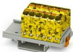
Verteilerblock, die Blöcke sind untereinander über den Leiterschacht brückbar, passende Steckbrücken siehe Zubehör, Block mit senkrechter Ausrichtung, Nennspannung: 800 V, Nennstrom: 32 A, Anschlussart: Push-in-Anschluss, Querschnitt: 0,2 mm<sup>2</sup> - 6 mm<sup>2</sup>, Montageart: NS 35/7,5, NS 35/15, Farbe: schwarz/gelb
