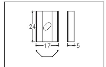
Halter-Set, silber. Material: Aluminium, Abmessung Profil: L: 24 mm x B: 17 mm x H: 5 mm .
