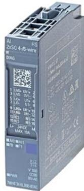
SIMATIC ET 200SP, analoges Eingangsmodul, AI 2x SG 4-/6-Wire High Speed, passend für BU-Typ A0 Farbcode CC00, Kanal-Diagnose, 28/16 Bit, +/-0,05% für DMS-Vollbrücken
