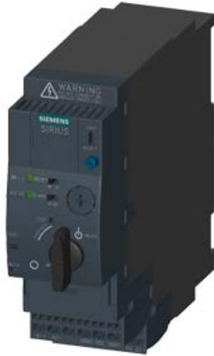
SIRIUS, KOMPAKTABZWEIG, DIREKTSTARTER 400 V, AC/DC 110 ... 240 V, 50 ... 60 HZ, 8 ... 32 A, IP20, ANSCHLUSS HAUPTSTROMKREIS: STECKBAR, OHNE KLEMMEN, ANSCHLUSS HILFSSTROMKREIS: FEDERZUGANSCHLUSS
