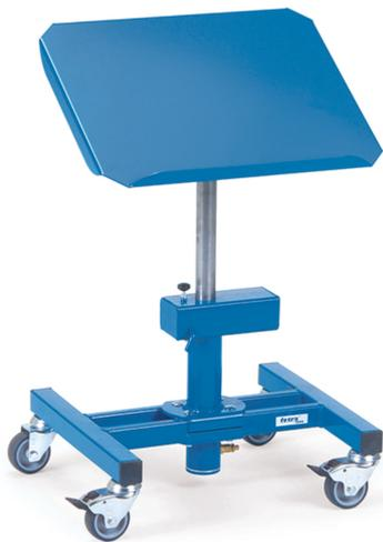
Für Kunststoffkästen, Stahlblechkästen, Drahtkörbe usw., höhenverstellbar und fahrbar. Profilstahl-/Rohrkonstruktion mit Stahlblechplattform. Plattform mit einseitiger Anlegekante, neigbar um 15° und 30°, stufenlos höhenverstellbar, dreh- und arretierbar, mit pneumatischer Absenkämpfung. Pulverbeschichtet blau RAL 5007. 4 Lenkrollen, Naben mit Gleitlagerung, 2 davon mit Feststeller gemäß der Europäischen Norm EN 1757-3 (Sicherheit von Plattformwagen). 3290: 510 - 700 mm höhenverstellbar
