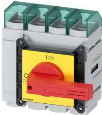
SETRON, Lasttrennschalter 3LD5 UL, Not-Aus-Schalter, 4-polig, approbiert nach UL489, UL60947-4-1 und IEC60947-3, UL: 100A, SCCR 65kA at 480VAC, Betriebsleistung @ 480VAC 3-phasig: 60hp, IEC: 100A, Betriebsleistung bei AC-23A bei 400V: 45kW, Frontbefestigt: Drehantrieb, rot/gelb, 4-Loch Befestigung der Handhabe , inklusive Klemmenabdeckungen für die Einspeiseseite
