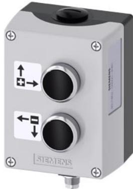
Gehäuse für Befehlsgeräte, 22 mm, rund, Gehäusematerial Metall, Gehäuseoberteil grau, 2 Befehlsstellen Metall, B=Drucktaster schwarz, 1S, Federzuganschluss, Bodenbefestigung, Schild silber, Schrift schwarz, mit grafischem Symbol: VOR RAUF PLUS, A=Drucktaster schwarz, 1S, Federzuganschluss, Bodenbefestigung, Schild silber, Schrift schwarz, mit grafischem Symbol: ZURUECK RUNTER MINUS, M12-Stecker (5-polig) unten, isolierte Reserveadern, Schilder eingeklebt
