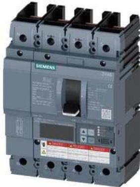
Leistungsschalter 3VA6 UL Frame 250 Schaltvermögenklasse C 100kA @ 480V 4-polig, Anlagenschutz ETU856, LSI, In=250A Überlastschutz, 100% rated Ir=100A...250A Kurzschlusschutz Isd=0,6..10x In, li=1,5..10x In N-Leiterschutz einstellbar (OFF, bis 100%) Erdschlussalarm Meldung über EFB300 o. COM ohne Anschluss
