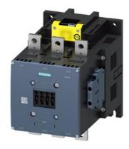
Leistungsschütz, AC-3 500 A, 250 kW / 400 V Spule AC 50/60 Hz und DC 96-127 V x (0,8-1,1) F-SPS Eingang 24V DC 3-polig Baugröße S12 Hilfskontakte 2 S + 2  $\ddot{\text{O}}$  Hauptstr.: Schiene Steuer- und Hilfstromkreis: Schraubanschluss
