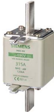
NH-Sicherungseinsatz, NH3, In: 355 A, aM, Un AC: 690 V, Stirnkennmelder, spannungsführende Griffflaschen
