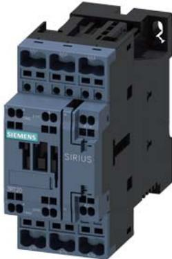
Bahnschütz, AC-3 17 A, 7,5 kW / 400 V 1 S + 1 Ö mit elektronischem Antrieb DC 24 V, 0,7-1,25\* US, mit Varistor integriert, 3-polig, Baugröße S0, Federzuganschluss
