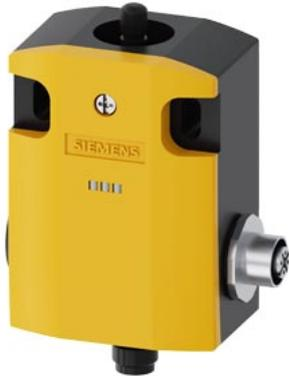
Basisschalter ohne Antriebskopf Metallgehäuse, 56 mm breit ASIsafe integriert AS-i Status: 1:F-IN1, 2:F-IN2 3:AS-i/FAULT Sprungschaltglieder 1Ö mit M12-Stecker 4-polig Kanal 1 an Ö, Kanal 2 an M12-Buchse rechts
