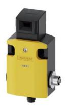
Sicherheits-Positionsschalter mit getrenntem Betätiger 5 Anfahrrichtungen Metallgehäuse, 56 mm breit ASIsafe integriert AS-i Status: 1:F-IN1, 2:F-IN2 3:AS-i/FAULT Schleichschaltglieder 1Ö mit M12-Stecker 4-polig Kanal 1 an Ö, Kanal 2 an M12-Buchse rechts
