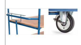
Compact et facile à utiliser, adapté à tous les chariots avec 2 roues fixes avec bandage TPE jusqu'à 600 kg.Poignée non enfoncée= Frein bloqué, le chariot reste sur place.Poignée enfoncée: le frein n'agit plus, le chariot peut être déplacé.Blocage sûr, loquet sur roue crantée.Non compatible pour un freinage en déplacement.Supplément par chariot. Ne peut être livré a postériori.
