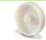
Rad, Traglast 130 kg, Mit Kunststoff-Bereifung, Durchmesser x Breite 125 x 37,5 mm, Nabe mit Gleitlager, Felge aus Kunststoff
