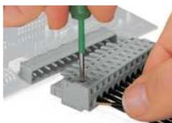
Leiter anschließen – Betätigung des CAGE CLAMP®-Anschlusses mit Schraubendreher (Klingenbreite 3,5 mm) – rechtwinklig zur Leiteranschlussrichtung.
