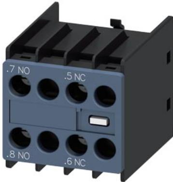
Hilfsschalter, frontseitig, 1 S + 1 Ö, 11 U, .7/.8, --/--, .5/.6, --/--, Strombahn: 1 S (voreilend), --, 1 Ö (nacheilend), --, Schraubanschluss, für Schütze 3RT2 und Hilfsschütze 3RH2
